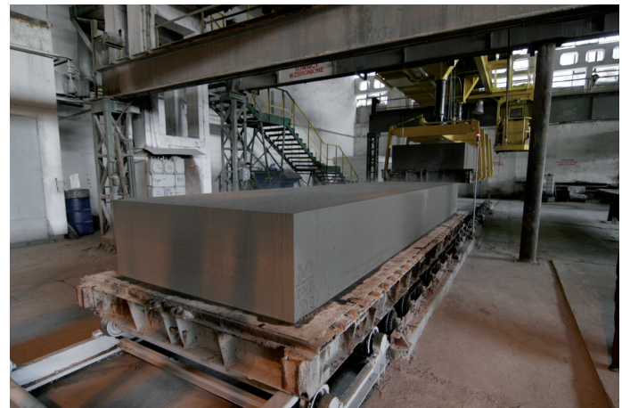
Rys. 5. Blok masy betonu komórkowego wyprodukowany z zastosowaniem popiołów fluidalnych przed procesem krojenia
